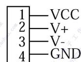
图 2 压力传感器接口
